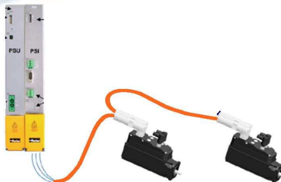
Esempio struttura di connessione
